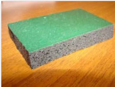
Основание – несипучее (бетон, асфальт, дерево, металлические поверхности и т.п.), не деформируемое, не должно быть тефлоновым, полиэтиленовым, из глазированной, не подготовленной, керамической плитки или полированной нержавеющей стали.
