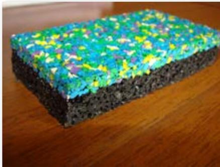
Основание – нессыпучее (бетон, асфальт, дерево, металлические поверхности и т.п.), сыпучее (гранитный и т.п. отсева, но не песок). Сыпучее основание должно быть хорошо утрамбовано, на него укладывается покрытие от 15 мм, с возможностью установки антивандальной сетки для дополнительной прочности.
