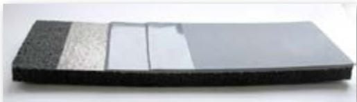
Основание – несыпучее (бетон, асфальт, дерево, металлические поверхности и т.п.), не деформируемое, не должно быть тефлоновым, полиэтиленовым, из глазированной, не подготовленной, керамической плитки или полированной нержавеющей стали. Должны отсутствовать смещения в вертикальном направлении одной части основания относительно другой части, не должно быть отклонений плоскости основания более чем на 2 мм на 3 кв.м.
