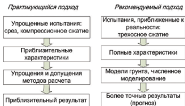
Рис. 2. Принципы взаимосвязи результатов лабораторных испытаний и геотехнических
