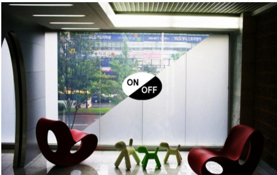
жидкие кристаллы пленки находятся в хаотичном порядке и делают перегородку или окно матовым, но под воздействием электрического тока принимают правильное положение и стекло становится прозрачным. За считанные секунды оно изменяет свое состояние от одного к другому.
