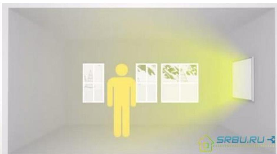
Принцип обогрева инфракрасным обогревателем.
