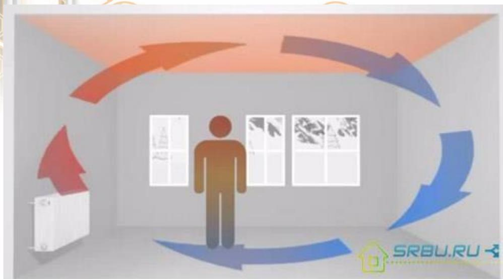
Перемещение воздушных масс при конвекции.
